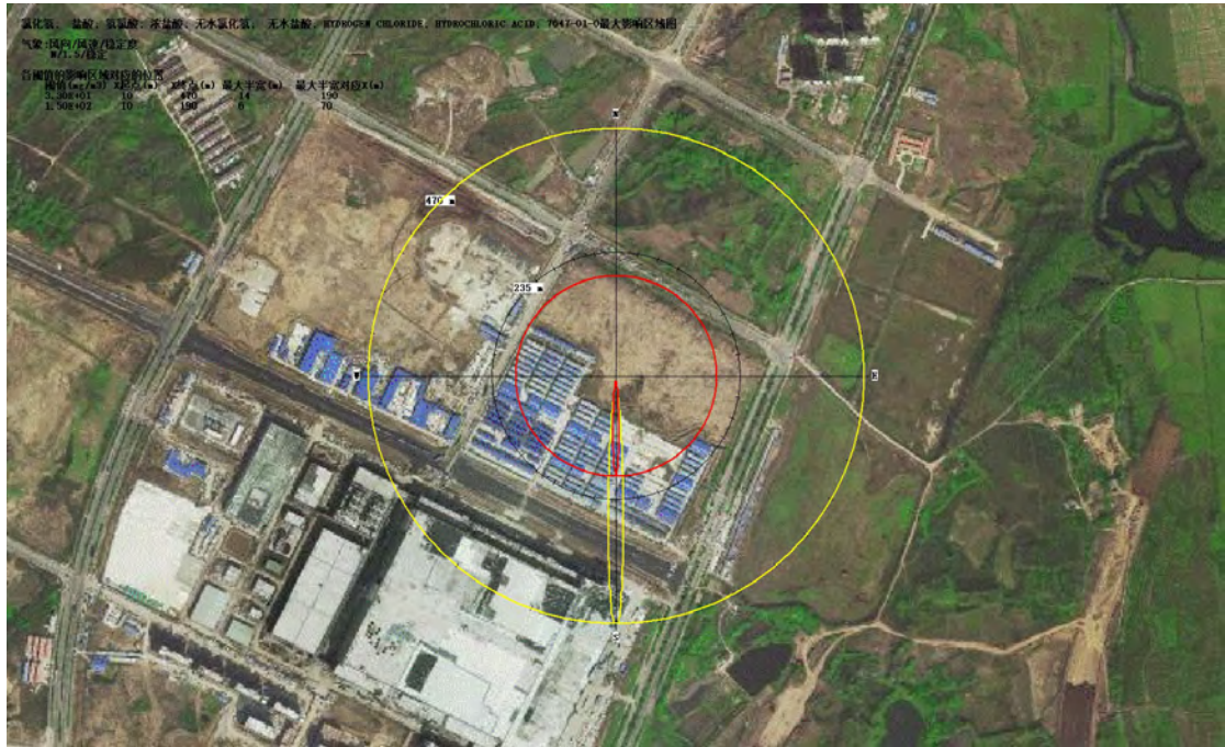
图6.3-7 F 稳定度 HCL 最大影响区域图
