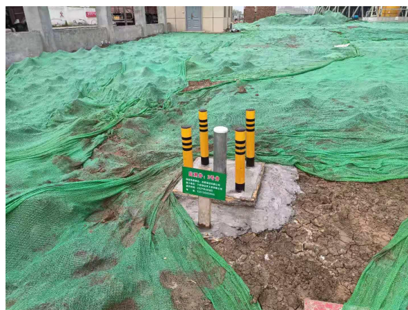
DW2 地下水监测井
