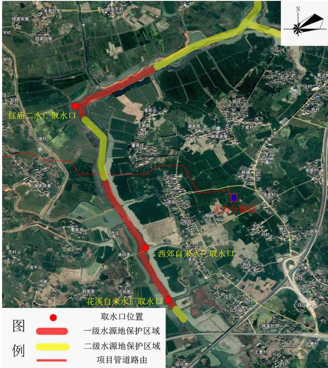
图 3.5-1 项目管道穿越花渡河北河示意图
