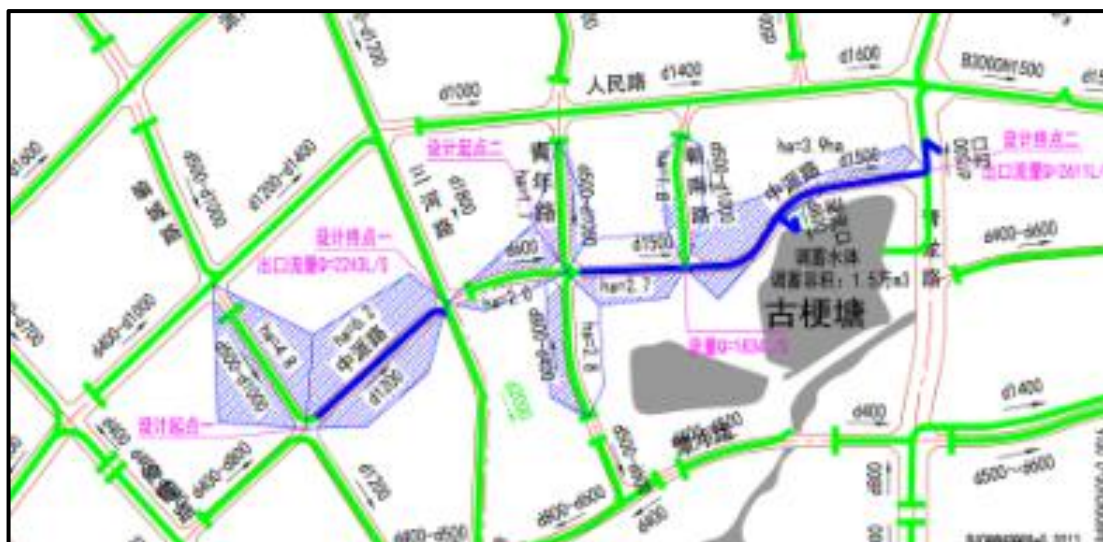
图 1.2-6 项目雨水设计系统图
