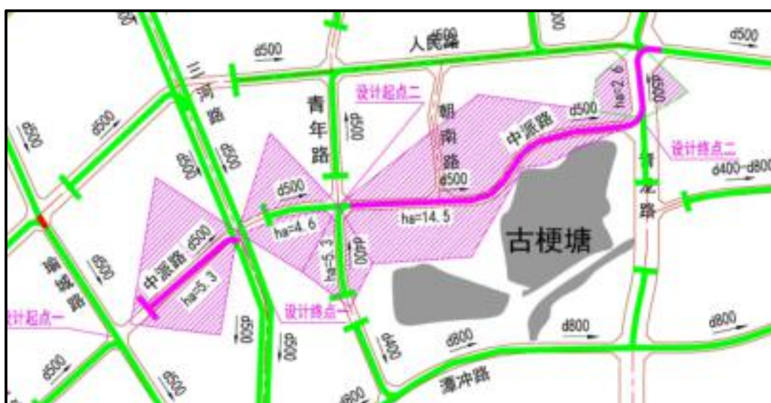
图 1.2-7 项目污水设计系统图
