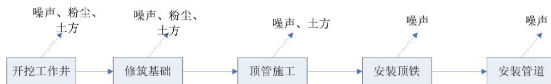
图 4-2 顶管施工工艺流程及产污节点图
