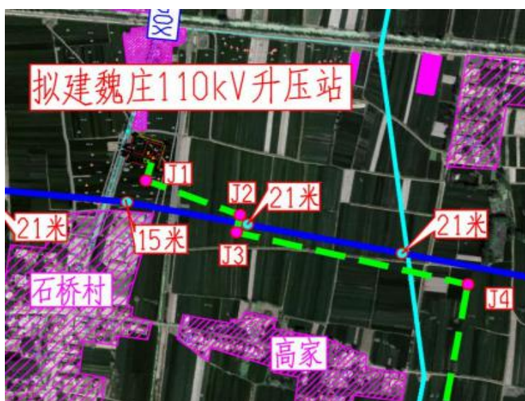
图 4-2 线路钻越 110kV 高圣荆 511 线平面示意图
