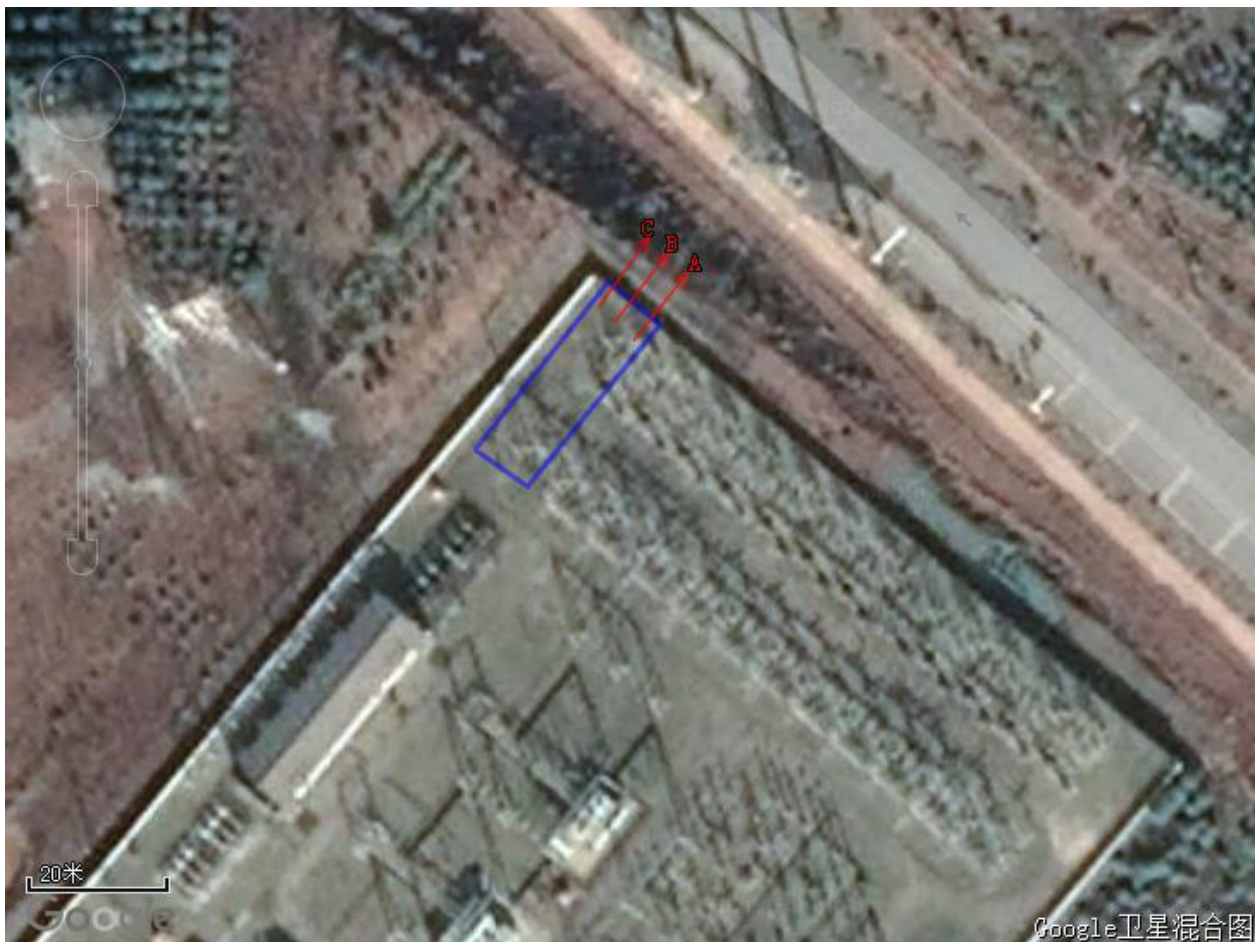
图 4-4 220kV 雄路变本期 110kV 进线示意图
