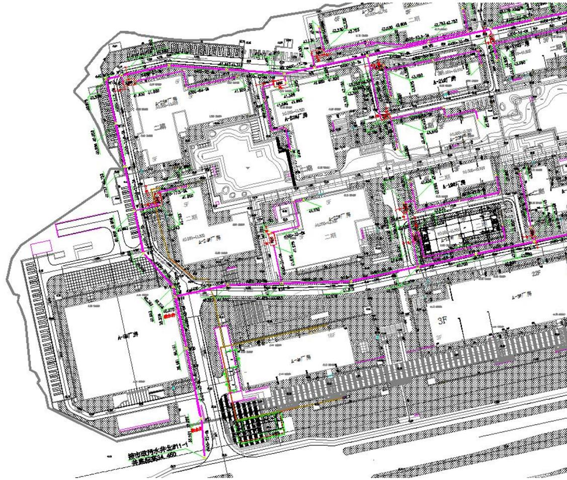
附图 5 雨污管网图
