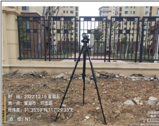
项目现场噪声监测
