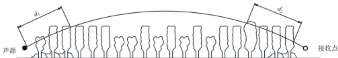
图 5-6 通过树和灌木时噪声衰减示意图
