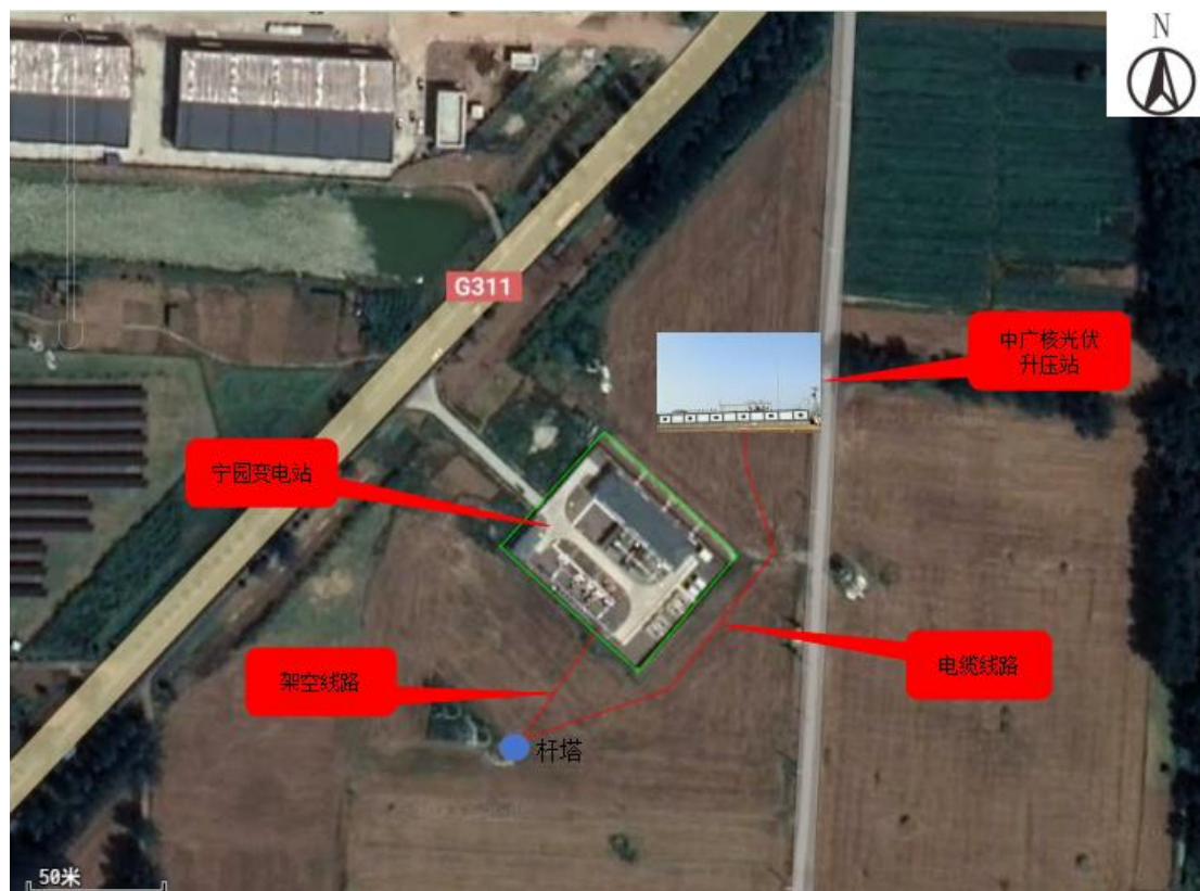
图 4-1 110kV 光伏升压站 110kV 出线布置图
