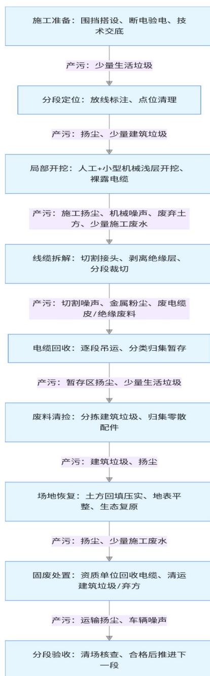
图 4-1 拆除施工工艺流程图
