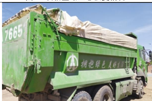
图 7 渣土车篷布覆盖抑尘
