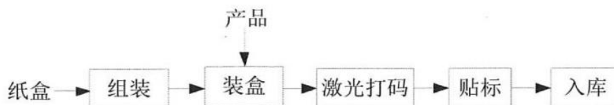
图 2-3 包装工艺流程及产污环节图
